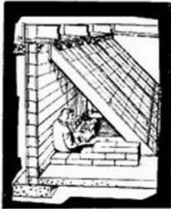
Schron zbudowany w piwnicy z rusztowania z drewna i cegieł
